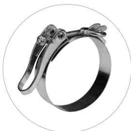
В качестве альтернативы, затвор хомута **NORMACLAMP® SVS** может быть оснащен болтом с проушиной. Это может быть особенно полезно, если во время установки используются перчатки. Доступен в вариантах ширины ленты 15, 20 и 25 мм по запросу.
